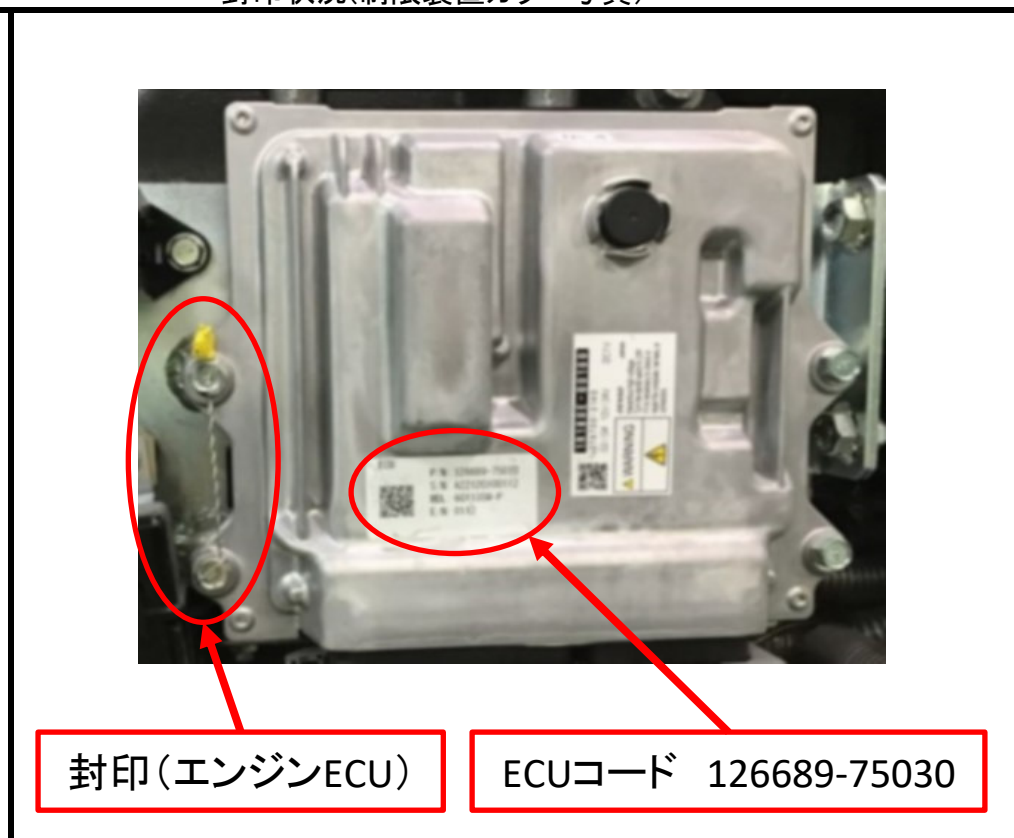
封印状況(制限装置カラー写真)
