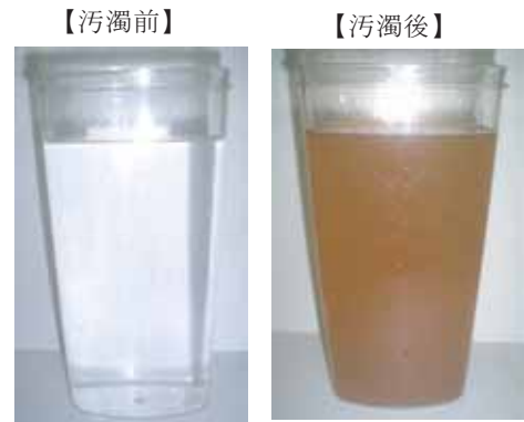
図Ⅲ.2-59 汚濁前後の状態
