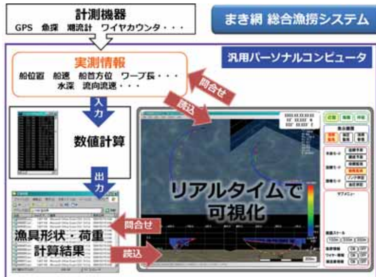
図Ⅲ.4-3 リアルタイムで可視化する原理図
