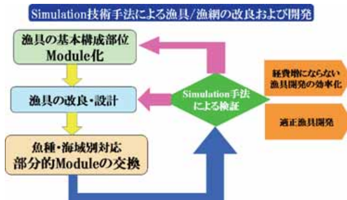
図Ⅲ.5-1 網漁具のブロックモ ジュール化の考え方
