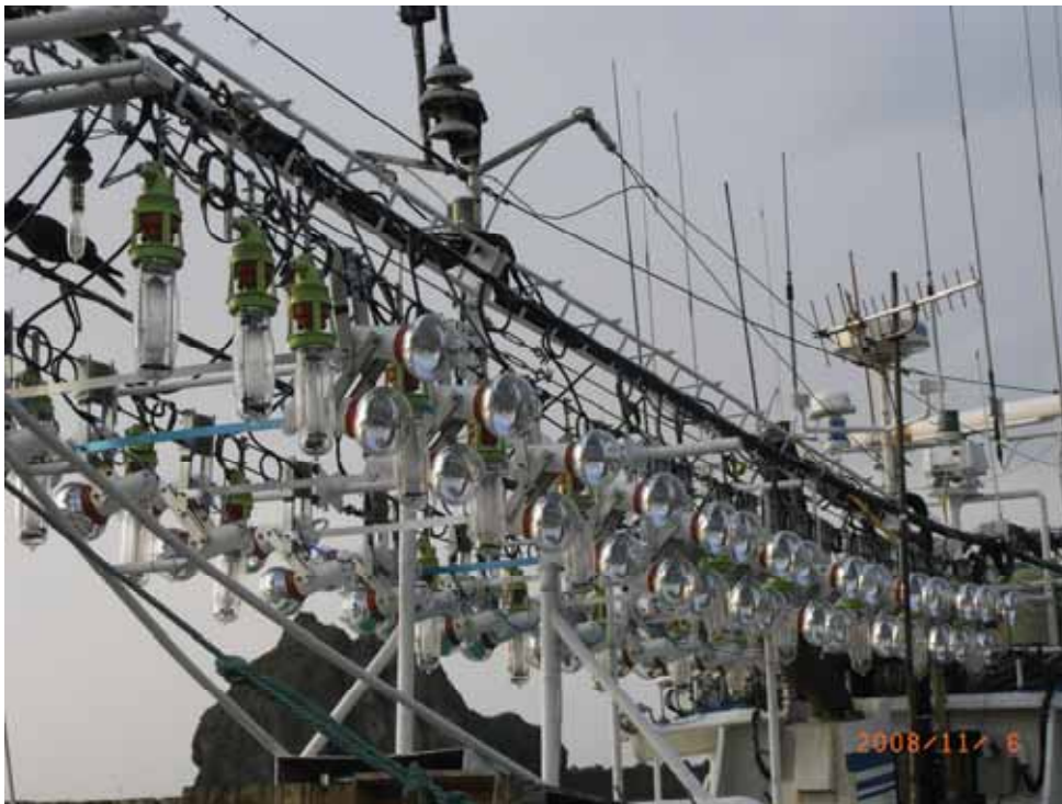
図 III.2-11 ランプ配置変更後 (B 配置) の栄保丸
