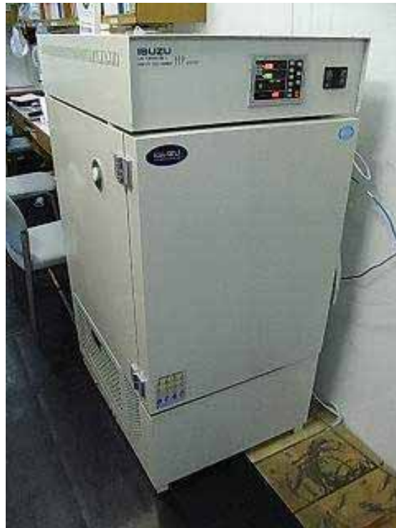
図Ⅲ. 3-7 作製試料保管庫 (低温恒温器)
